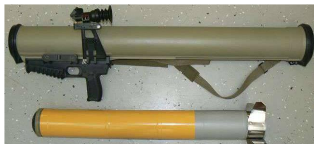
РПО-М «Шмель-М» (Эффективная дальность – до 300 м. зона поражения – 50-80 кв.м)
