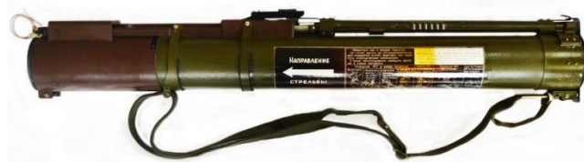
РПГ-22 «Нетто» (Эффективная дальность – до 150 м. бронепробиваемость – 400 мм)
