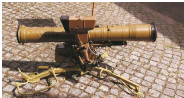
ПТРК 9К112 «Фагот» Ракеты: 9М111 Д max – 2000 м, min – 70 м. б/пр-ть – 400 мм 9М111М Д max – 2500 м, min – 70 м. б/пр-ть – 500 мм 9М113 Д max – 3500 м, min – 70 м. б/пр-ть – 600 мм
