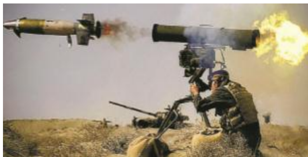
ПТРК 9К135 «Корнет» (Дальность: max. – 5500 м, min. – 100 м. бронепробиваемость – 1200-1300 мм)
