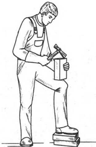
Рис. 18. Положение человека при теске кирпича
